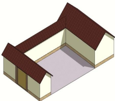
Abbildungen: Schema eines Dreiseithofes mit überbautem Hofator und traufständigem Wohnhaus Quelle: Eigene Darstellung
